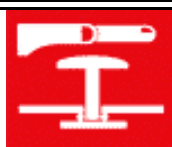
pulsante di sgancio elettrico generale
