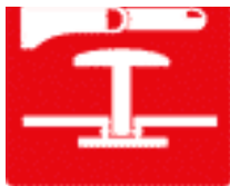
pulsante di sgancio elettrico generale
